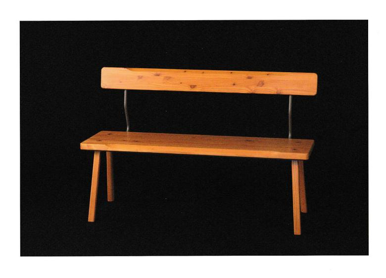
出来るだけ素朴に落葉松の素材感を生か したデザインにしたかったのですが、だか らと言って重厚な素材感強調のデザインに はしたくありませんでした。座・背とも、 反りや割れの防止用の桟は付けず、厚みの ほぼ中央に穴を貫通させスチールパイプを 通しその桟の役目を代行させ同時に座と背 の連結も兼ねさせました。
